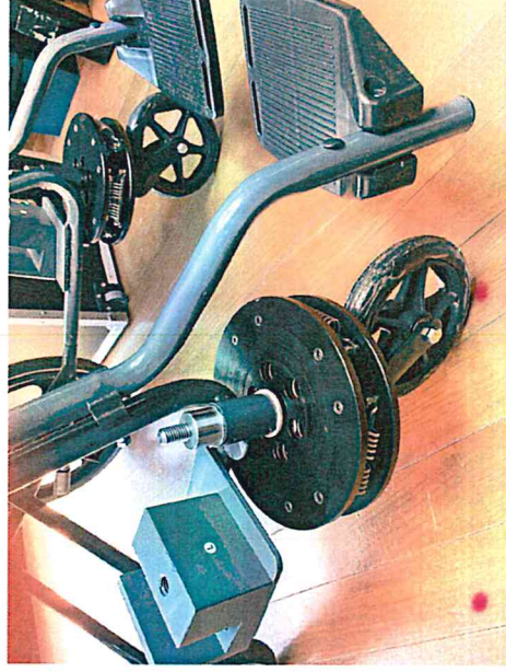
左右車輪用強化スプリングシステム 6個のスプリングと航空、船舶でも利用されている防振装置を兼ね備えた強力な防振器具
