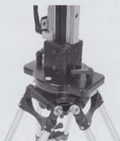
写真2 センターポールと三脚の接続は、カメラの安定につながってくる部分のため、遊びのないようにしっかりと固定する必要がある
