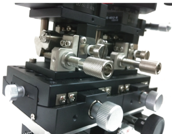
傾斜部及び高さ部調整
