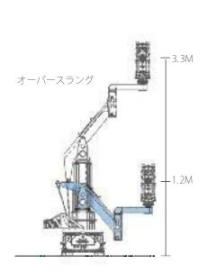
パフォーマンス マキシマムスピード Axis 可動距離 トラック as required 3m/秒 リフト +3.3m~-.25m 75m/秒 ローテート アンリミテッド 40°/秒 パン
