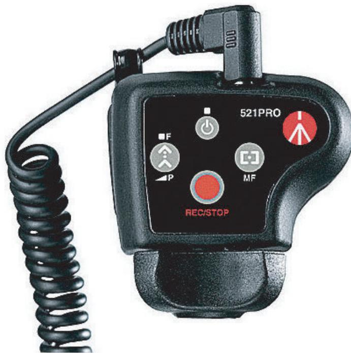
LANC端子を採用したSONY、CANONカメラ用ズームフォーカスコントローラー。ズーム操作の他、POWERのON/OFF、フォーカス調整、RECのSTART/STOPが可能。三脚のパン棒に取り付けられたローアングル撮影時にも非常に有効です。また、任意のズームスピードをメモリーさせることが可能です。
