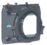
MB-315はブロードキャストカメラ用マットボックスで、自重は490gです。標準装備はマットボックス本体、特許取得済みアイブロー、フレンチフラッグ、取り付けられるフィルターは3×3から4×6までのフィルターでフィルタートレイは4×4回転式トレイ、4×4固定式トレイがそれぞれ各1つ、フィルターフレームが2点です。レンズの使用最大径は105mmです。
