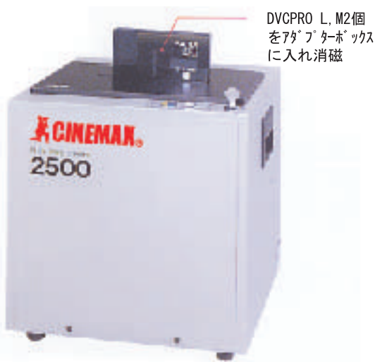
カセットエレベーター DVCPROをアダプターボックス に入れて使用 セレクター-S, M 電源キースイッチ スタートボタン
