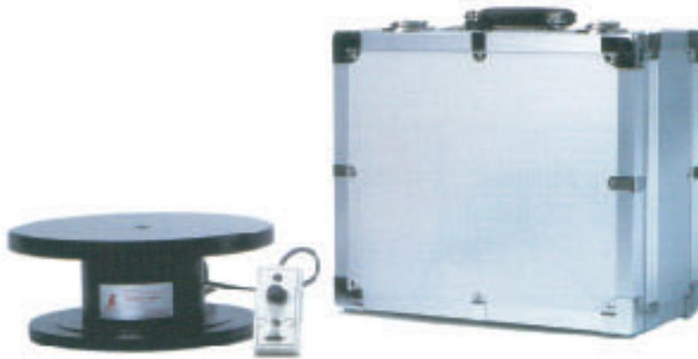
CMX1000はDCバッテリー12V PB-90 1個使用にて回転します。軽量なので持ち運びが便利です。スピードはバリエーション方式、正転、逆転も可能です。スイッチを切るとその場で停止します。テーブルの大きさは直径300mmです。最大搭載質量は、15kgです
