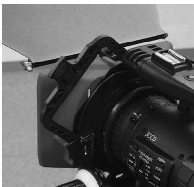
写真4、5 回転式の4×4インチフィルタートレーと、レンズ前面に固定式の4×4インチフィルタートレーが装備
